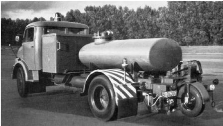
Sehr bekannt wurde Riekerts Prüfverfahren für die Griffigkeit des Reifens beim Bremsen auf trockener und nasser Fahrbahn, der „Stuttgarter Reibungsmesser“.
